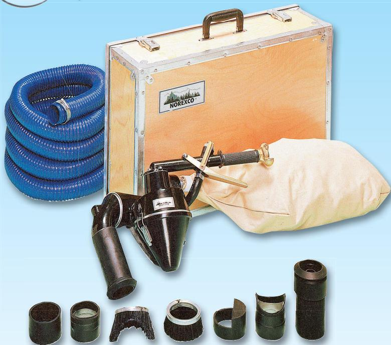
**NORBLAST® 6** est une sableuse portative, légère à récupération d'abrasif. Sans pièces mobiles, elle fonctionne à air comprimé, avec des abrasifs réutilisables : grenailles métalliques, scories, oxydes d'alumine, carbures de silicium ou billes de verre.
